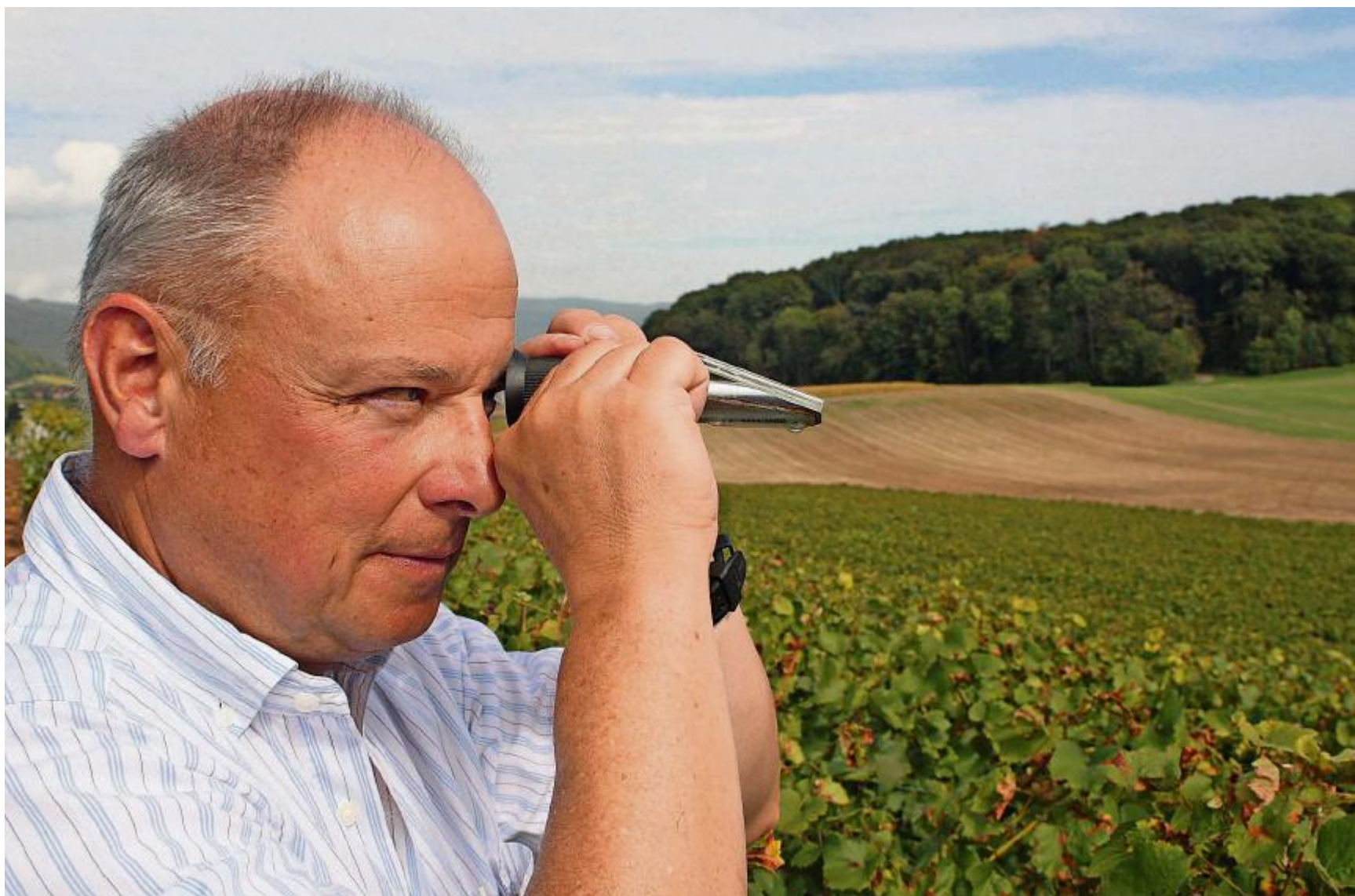
Laurent de Coulon, Chef der Weinfirma Buess, blickt in einen Refraktometer, mit dem er den Zuckergehalt der Trauben messen kann.
